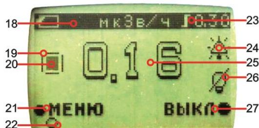
Во время замеров важно обращать внимание на индикатор точности (поз. 19 на дисплее) – когда он окружает с 4-х сторон индикатор обнаружения радиационных частиц, то можно фиксировать в своих протоколах значение основного измеряемого параметра. Время окружения индикатора – около двух минут и зависит от уровня радиации – чем он больше, тем короче время установления.
